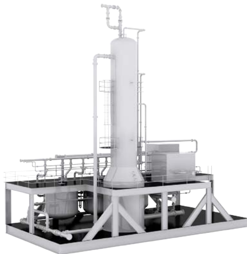
Unidad de Tratamiento de Agua de Mar
